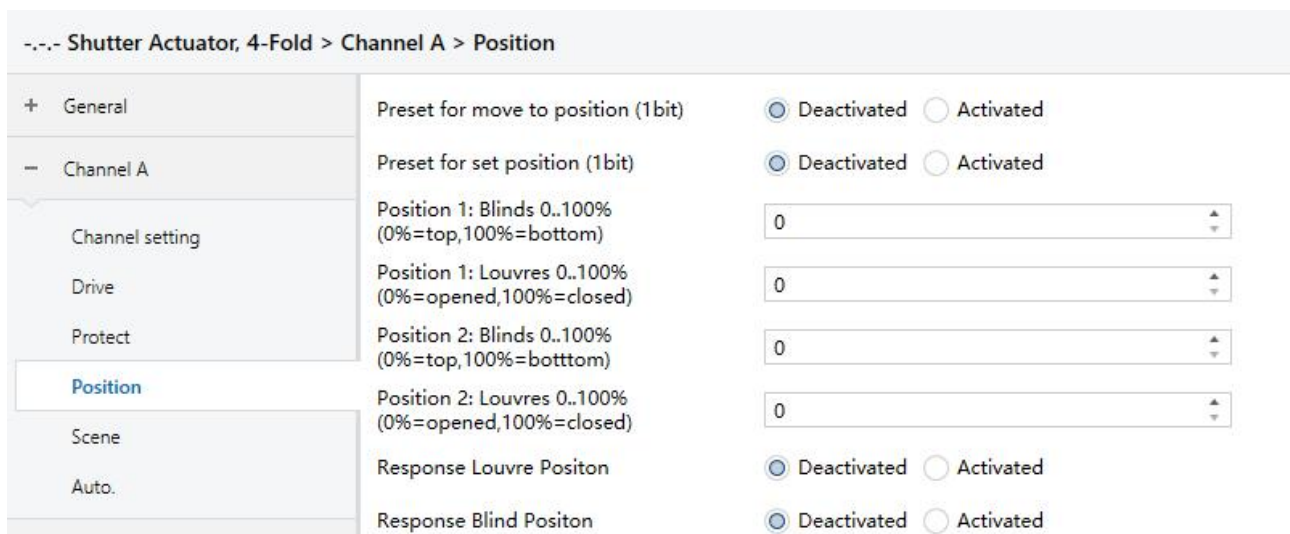
Fig.5.6 parameter window “Position”
