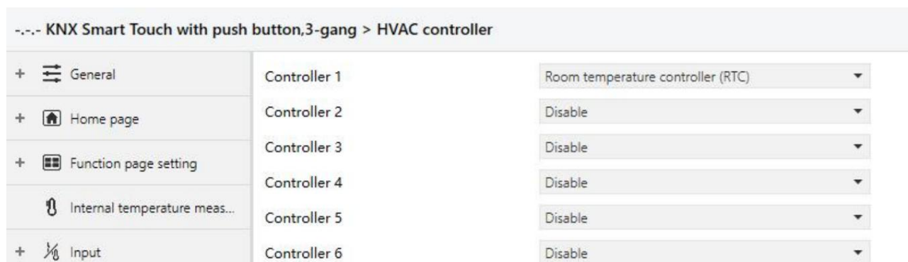
Fig.5.4 Janela de parâmetro "controlador HVAC"
