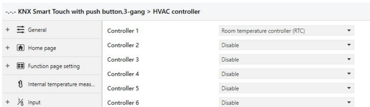
Fig.5.4 “HVAC controller” parameter window
