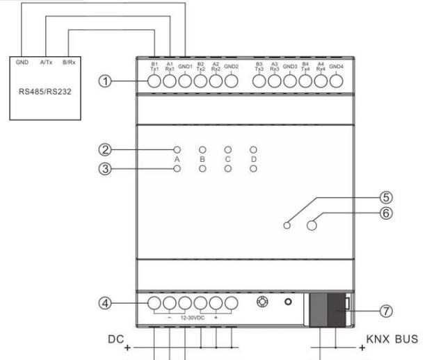
**FIGURA DE INSTALAÇÃO****• Interface RS485/RS232**
